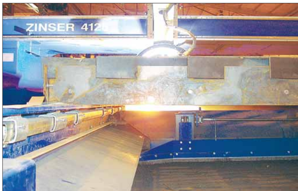
Udsugningsvognen følger skærehovedet og letter også rengøringen ved at opsamle slagger.
