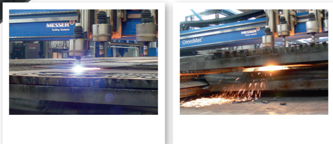
4 x 200 A plasmabrændere. Ingen røg eller støvbelastning til produktionslokalet.
